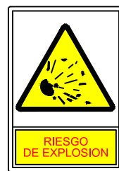
SEÑAL 5 PELIGRO DE EXPLOSION
